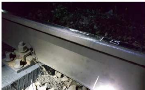
Șina de pe firul interior al curbei - pct.B - prima urmă în sensul de mers al trenului pe fața laterală activă a ciupericii șinei firului interior al curbei
