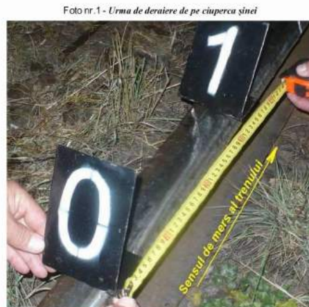
Foto nr.2 - Urma de deraiere, puncte de escaladare („0”) și de cădere („1”)
