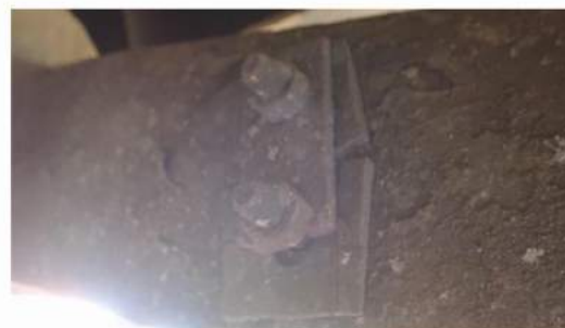
Fotografia nr.8 Sistem prindere etrier siguranță roata nr.8
