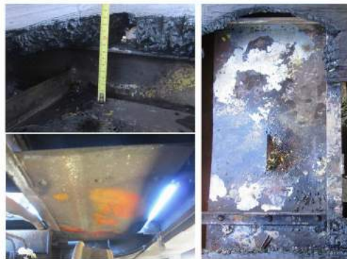
Foto nr.3, tabla parascântei aferență roții nr.4 (vedere de jos, de sus și distanță față de podeaua vagonului)
