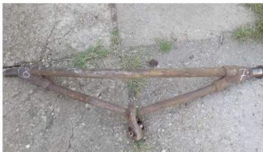
Fotografia nr.14.Axă triunghiulară osia 7-8 deformată
