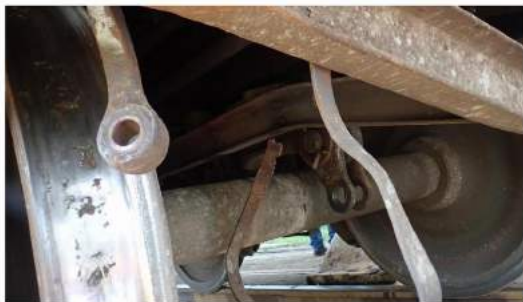
Fotografia nr.10 Etrier siguranță, rupt roata nr. 7
