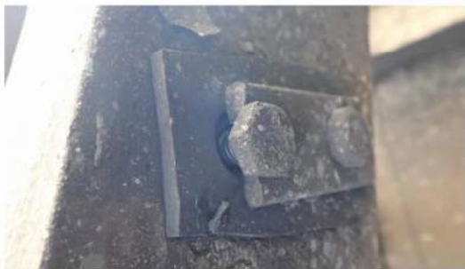
Fotografia nr.11. Etrier siguranță rupt roata nr. 5
