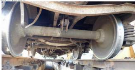
Fotografia nr.13.Etrier siguranță lipsa, roata nr. 8;
